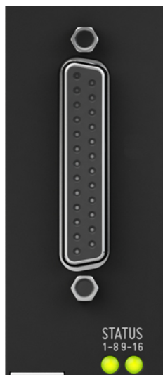
Fig. 35: D-sub 25 status LEDs
